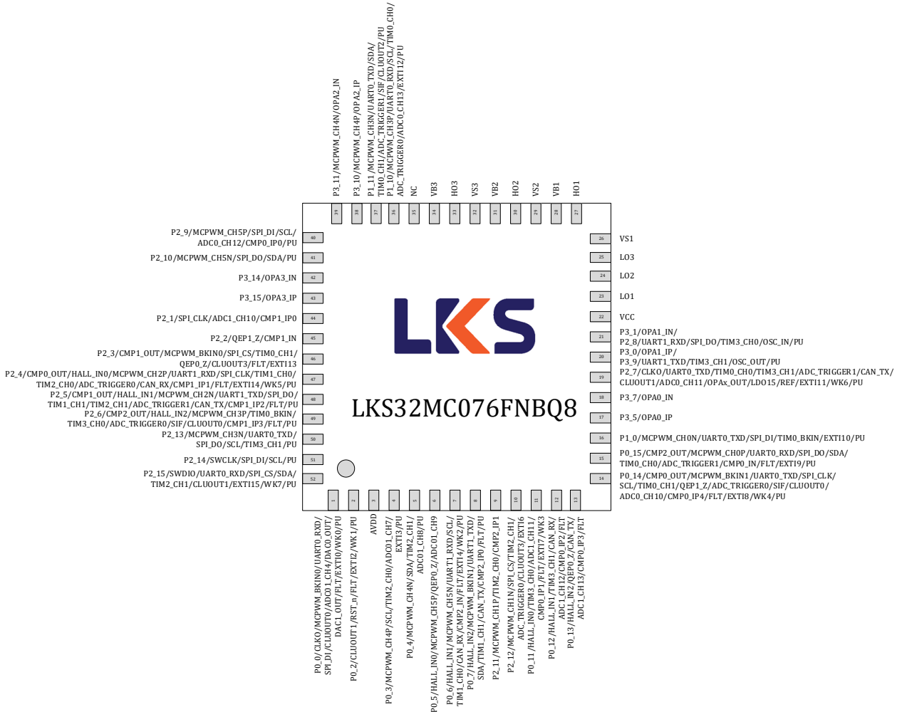
图 3-11 LKS32MC076FNBQ8 管脚分布图
